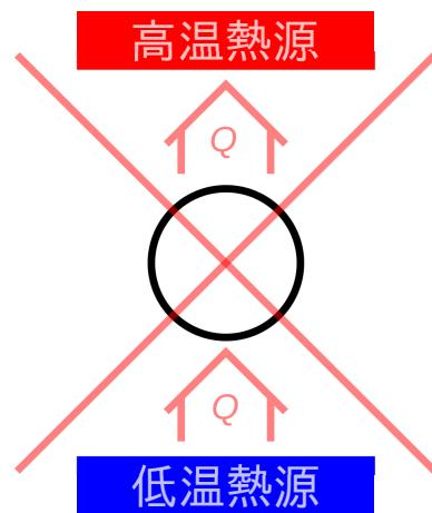
図 1.3 クラウジウスの原理
