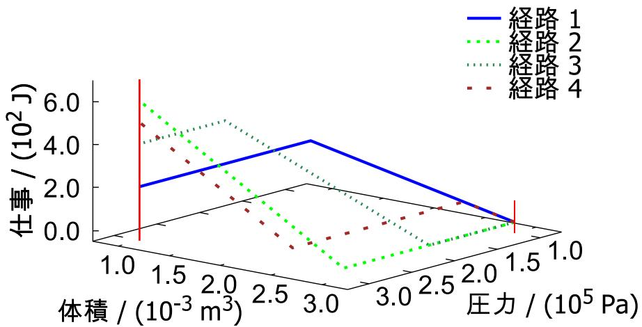
図 B.1 経路による仕事の変化
