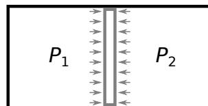
図 2.1 圧力と力学平衡
