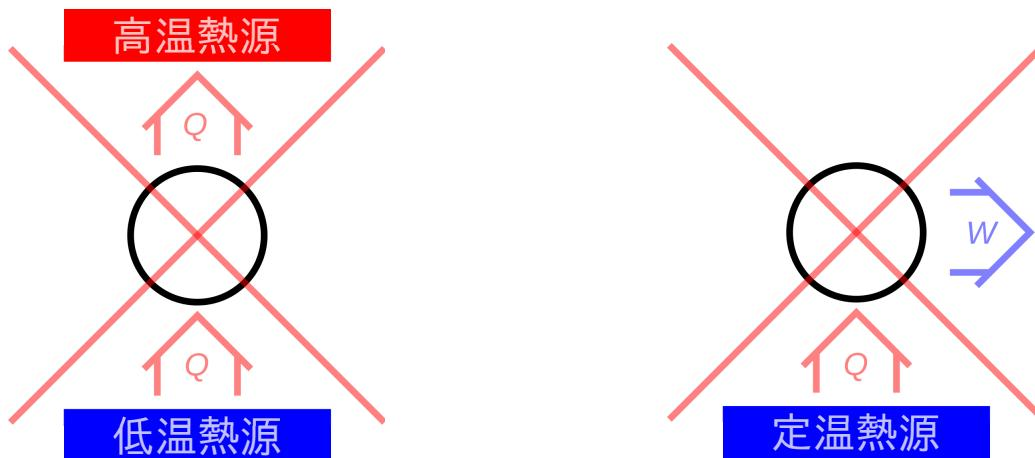
図1.3 クラウジウスの原理
