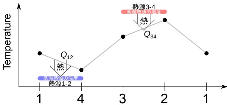
図 3.8 ピストンでの熱機関として動作するサイクルの温度変化
