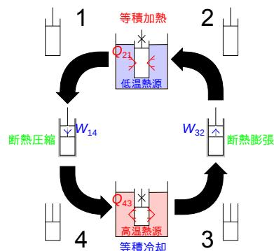
図 3.11 ピストンでのヒートポンプとして動作するサイクル
