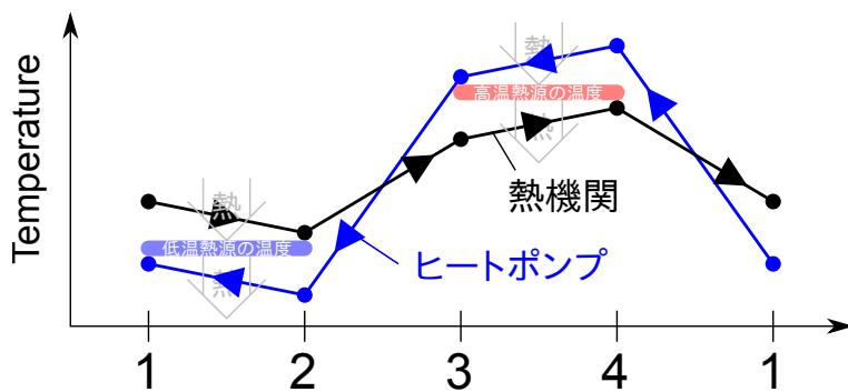
図 3.15 热機関とヒートポンプにおける温度変化
