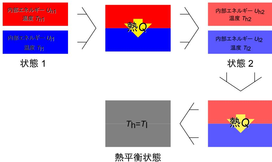
図 1.2 内部エネルギー・熱平衡
