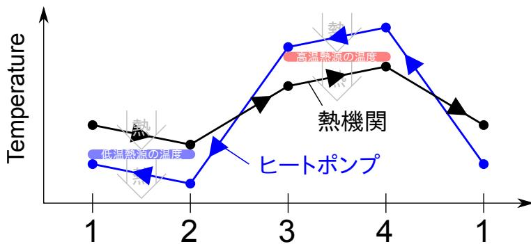
図 3.15 热機関とヒートポンプにおける温度変化
