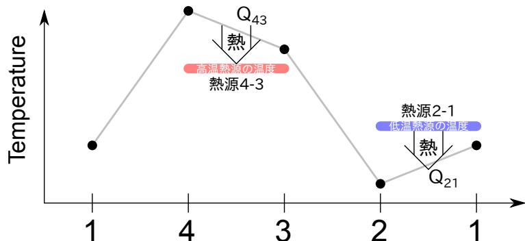
図 3.13 ピストンでのヒートポンプとして動作するサイクルの温度変化
