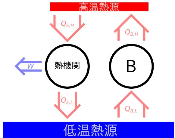
図 A.4 クラウジウスの原理
