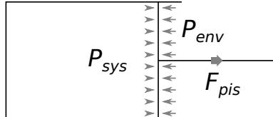
図 B.2 力の釣り合い(系の圧力が低い場合)
