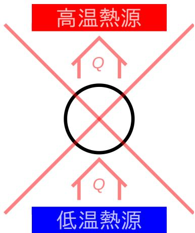
図 1.2 クラウジウスの原理
