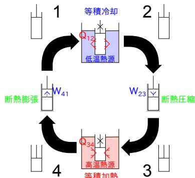
図 2.6 ピストンでの熱機関として動作するサイクル
