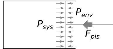
図 B.1 力の釣り合い(系の圧力が高い場合)
