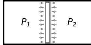
図 3.1 圧力と力学平衡
