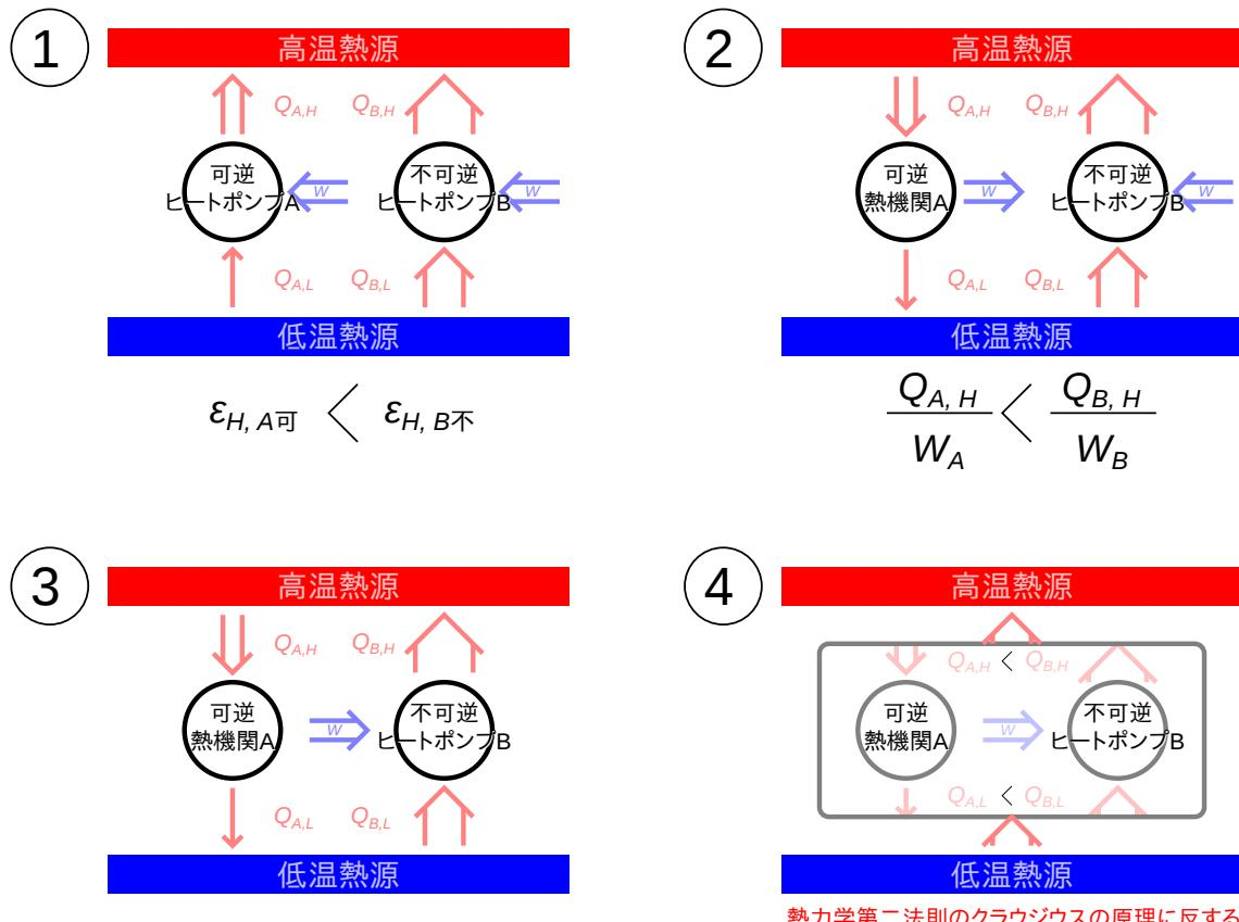
図1.6 可逆ヒートポンプと不可逆ヒートポンプの比較
