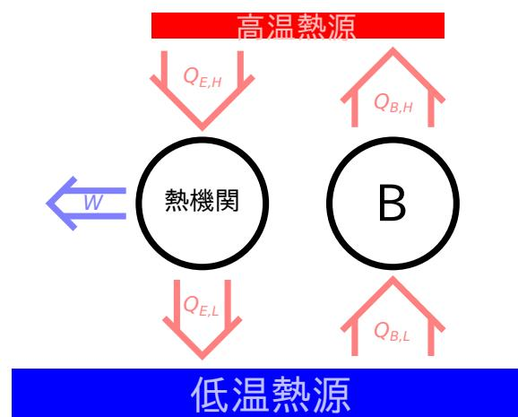
図 A.4 クラウジウスの原理
