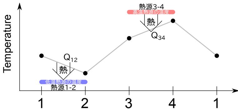
図 2.8 ピストンでの熱機関として動作するサイクルの温度変化
