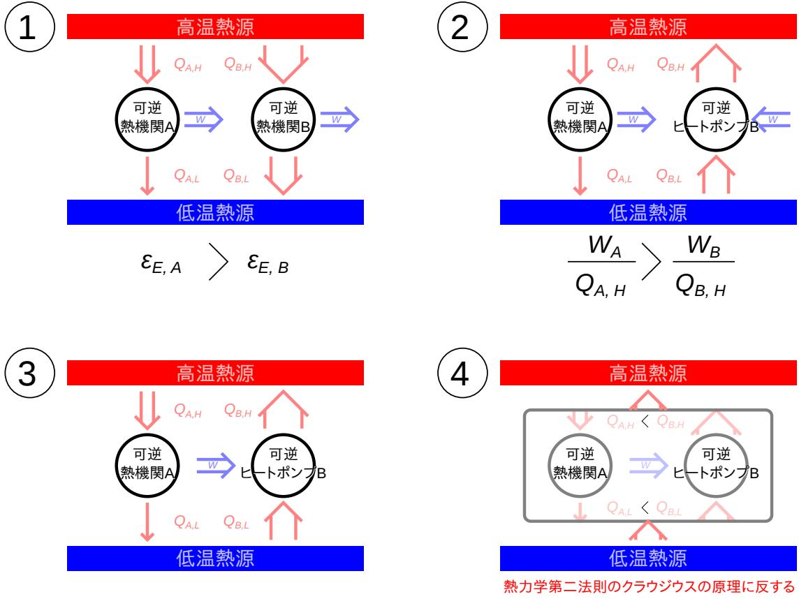
図 1.3 可逆熱機関（可逆ヒートポンプ）の比較
