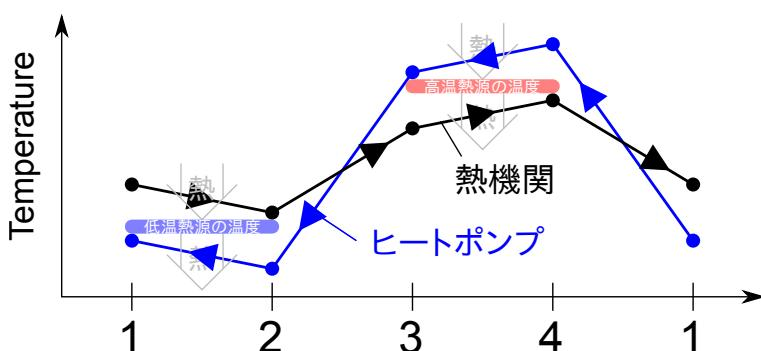
図 2.14 热機関とヒートポンプにおける温度変化
