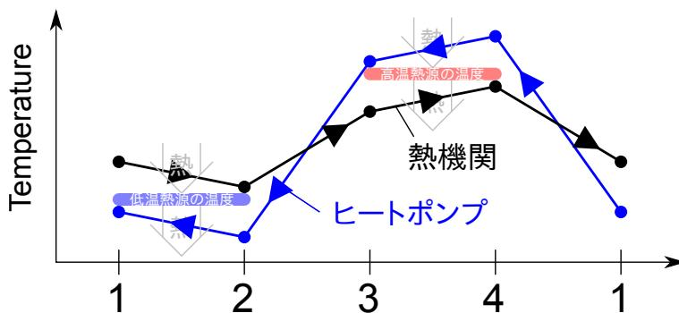
図 1.21 热機関とヒートポンプにおける温度変化
