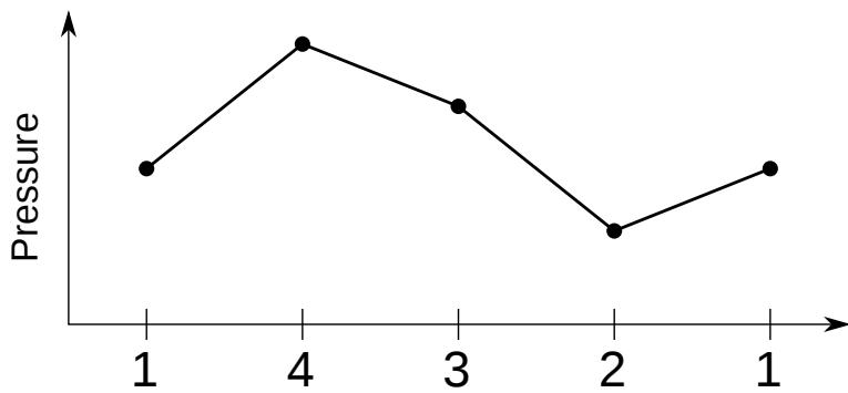
図 1.12 ピストンでのヒートポンプとして動作するサイクルの圧力変化
