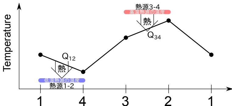
図 1.9 ピストンでの熱機関として動作するサイクルの温度変化
