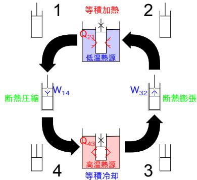
図 1.11 ピストンでのヒートポンプとして動作するサイクル
